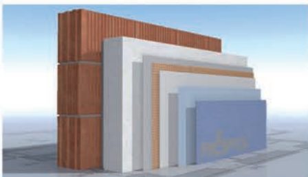
RÖFIX POLY EPS-Wärmedämmsystem und RÖFIX W50 EPS-Wärmedämmsystem (Standardsysteme) mit RÖFIX EPS-F 040 Fassadeämmplatte
